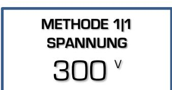
Bei der Durchführung eines Voltgradienten, geben Sie die gewünschte Endvolt ein. Die Startvolt ist der Endpunkt des vorherigen Schritts. Wenn der erste Schritt ein Gradient ist, ist die Startvolt null.
