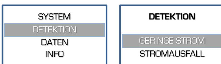
2. Entscheiden Sie, ob die Ausgangsspannung bei zu schwachem Ausgangsstrom den Lauf stoppen soll und bestätigen Sie mit ✓.
