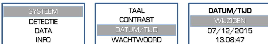
2. Stel achtereenvolgend dag, maand, jaar, uur, minuten en seconden in. Bevestig elk met ✓ of stop het ingeven van de overige door het drukken van ▶/■.
