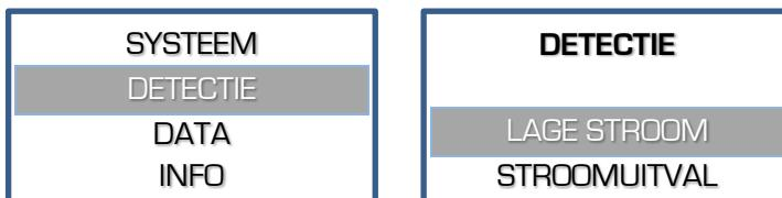
2. Kies of het toestel de procedure al dan niet moet stopzetten zodra een te lage stroom wordt gedetecteerd en bevestig met ✓.
