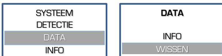
2. Er verschijnt een vraag om de gegevens te wissen. Kies **JA** en druk ✓ om te bevestigen dat de opgeslagen gegevens moeten worden gewist.
