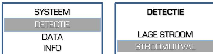
2. Kies of het toestel al dan niet de procedure verder dient te zetten voor de resterende tijd na een stroomuitval en bevestig met ✓.
