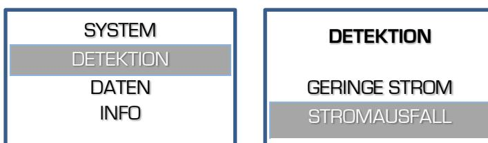
2. Entscheiden Sie, ob das Gerät nach einem Stromausfall mit dem Experiment für die Restzeit weiter laufen soll und bestätigen Sie mit ✓.
